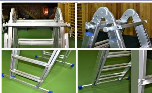
**Caracteristici generale** - latime tronsoane: **350 mm** - dimensiuni lonjeroane: **61,4 x 23 mm**- dimensiuni trepte: **28 x 28 mm**- grosime pereti lonjeroane si trepte: **1,3 mm** - distanta intre trepte: **280 mm**- balamale cu blocare automata din **otel zincat**- traverse din aluminu la baze-dopuri de plastic antiderapante la capetele traverselor de baza
